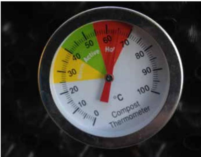
Nach 24 Stunden muss die Temperatur überwacht werden. Nach ein bis zwei Tagen steigt die Temperatur meist auf 70 °C. Wenn diese Temperatur erreicht ist, muss der Haufen aufgedeckt werden. Es beginnt das Intervallgießen, siehe Wassergehalt einstellen. Hat der Haufen einmal die richtige Feuchte, läuft er meist problemlos bei 65°C.
